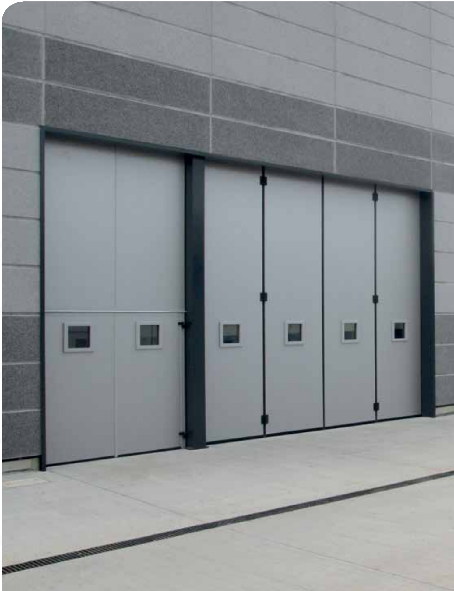
▲ Portoni a libro 4 ante costituiti da lamiera gofrata RAL 9006 Silver (lamiera speciale) e oblò fuori standard eseguiti con profilo facciata in alluminio Porte U.S. complete di serratura elettrica apribile con badge e maniglione antipanico motorizzato
